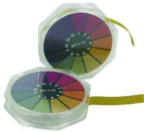
Déposer un morceau de papier indicateur de pH de 1 cm environ dans une soucoupe
